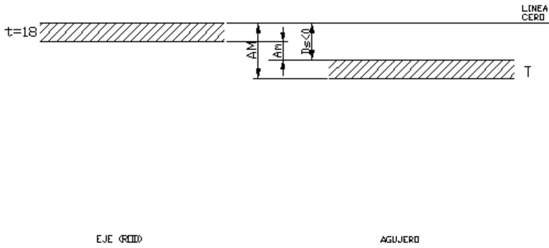
En las tablas de tolerancias para rodamientos se obtiene  $d_i = -18$  para un diámetro exterior de 130mm.
