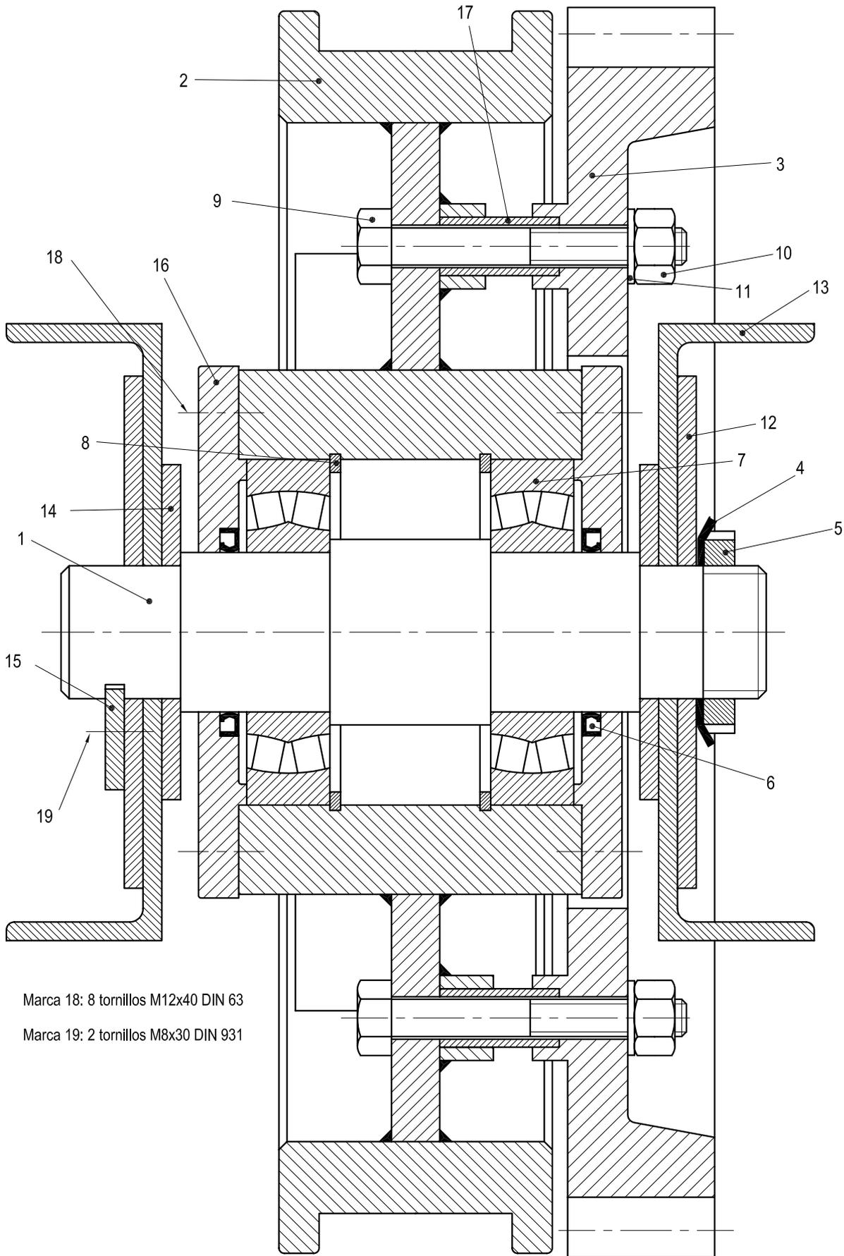
Marca 18: 8 tornillos M12x40 DIN 63
